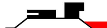
02_une plate-forme haute [les nouvelles activités sont à l'abri d'une crue maximale]
